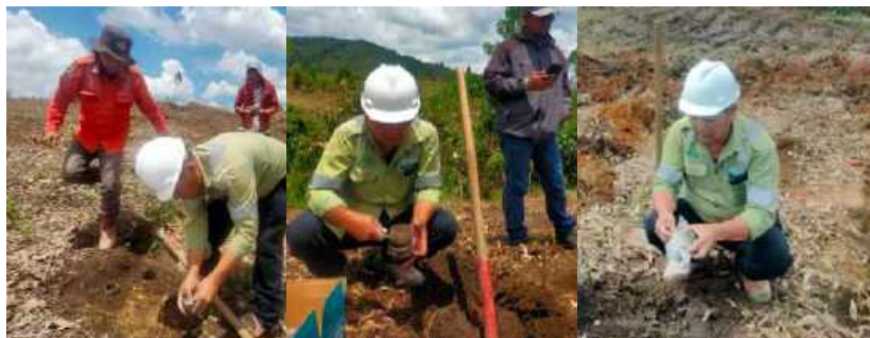
Gambar II-28. Pengambilan Sampel Kepadatan Tanah
