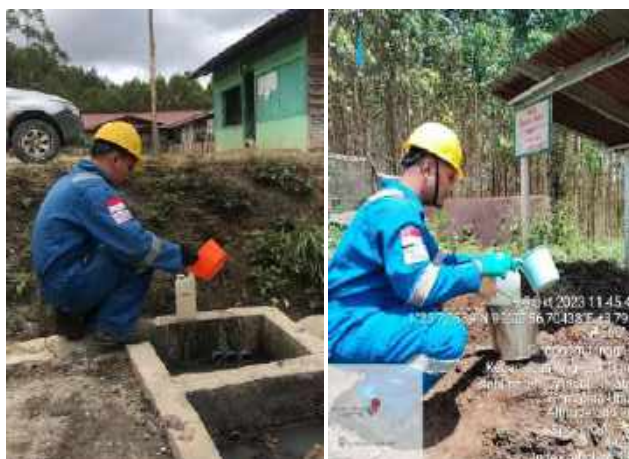
Gambar II-16. Pengambilan Sampel Air Limbah Perumahan
