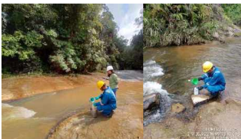
Gambar II-30. Pengambilan Sampel Air Sungai
